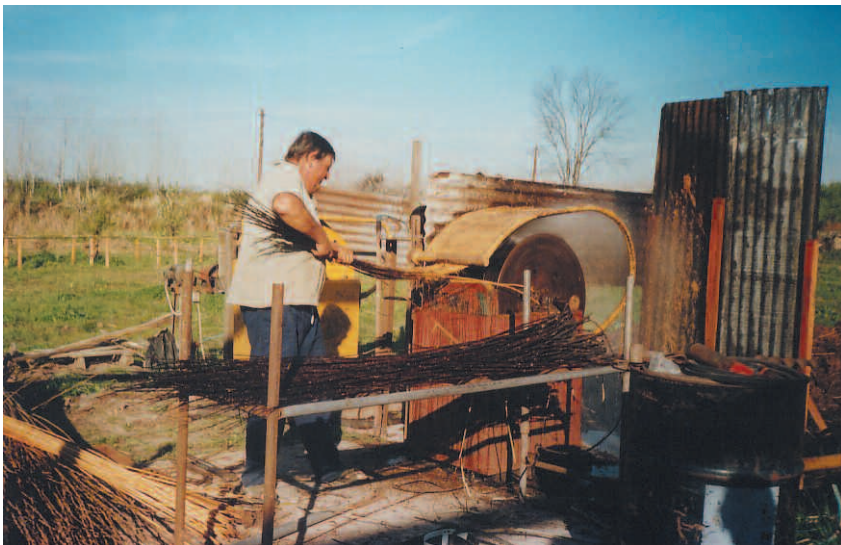
Foto n° 70. El mimbre ( Salix spp. ) y su procesado. Isleño pelando varas de mimbre en un peladera mecánica. En las islas del Bajo Delta se produce un gran porcentaje del mimbre del país, actividad en pleno auge. Foto: gentileza del Municipio de San Fernando.
